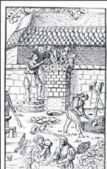
Bild 1: Frühneuzeitlicher Stückofen (A). Der Ofenmann gibt vom Treppchen (B) gerade Eisenerze (C) auf Rechts Erzhaufen (C), davor Holzkohlen (D). Die untere Ofenstimmwand ist im Bild hinter Lehmverstrich verborgen; sie wurde später aufgebrochen. An den senkrechten Bildrändern links Brechstange, rechts Haken-eisen, mit denen das „Stück“ auf den Hüttenflur gezogen wurde. Nach Agricola (1556/1961).
