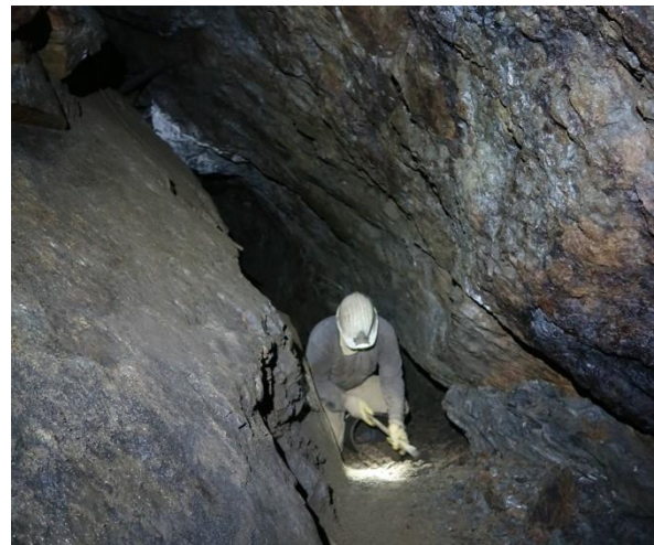
Gewinnung von feinem Material für die Trockenmauer (M. Halbas; Foto: J. Bertram, 10.05.2023)
