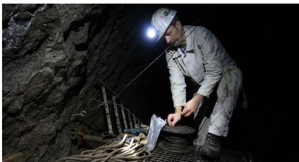
Neujustierung des Führungsdrattheils (J. Steinberg; Foto: J. Bertram, 27.05.2023)
