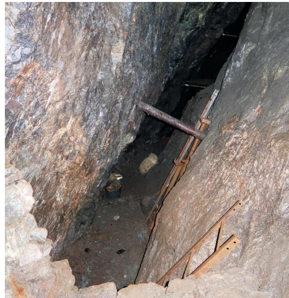
Hohlraumvolumen (Versatzkasten) für das Bergematerial aus dem Absinken 'Johannes I' (Foto: J. Bertram, 24.06.2023)
